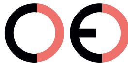
Falsche CE-Kennzeichnung (zu großer Zwischenraum)
